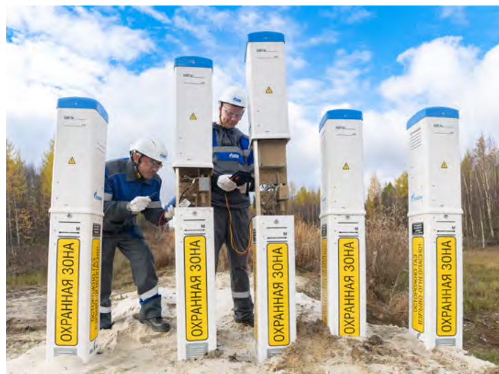
Монтеры по защите подземных трубопроводов от коррозии Александр Путинцев и Руслан Казаков проводят измерения защитных потенциалов подземных трубопроводов на контрольно-измерительных пунктах
