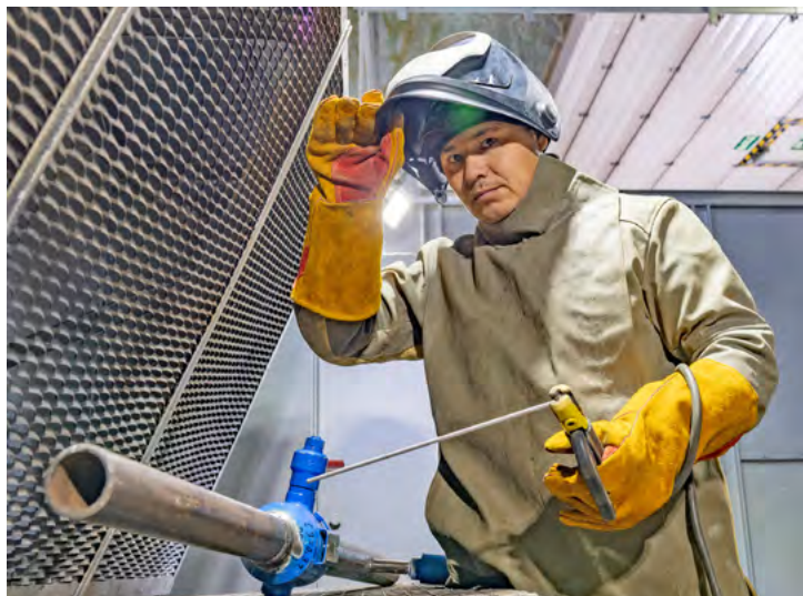
Электрогазосварщик Ринат Биктимиров производит сборку шарового крана
